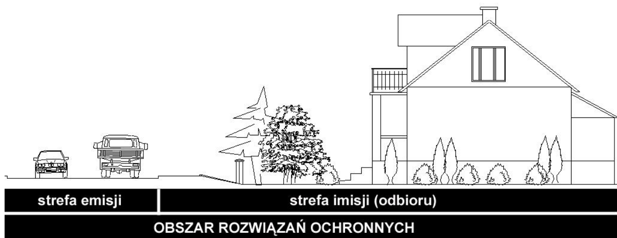
Rys. 6.5. Strefy emisji i imisji hałasu oraz obszar rozwiązań ochronnych w uniwersalnym podejściu do ochrony przed hałasem drogowym
